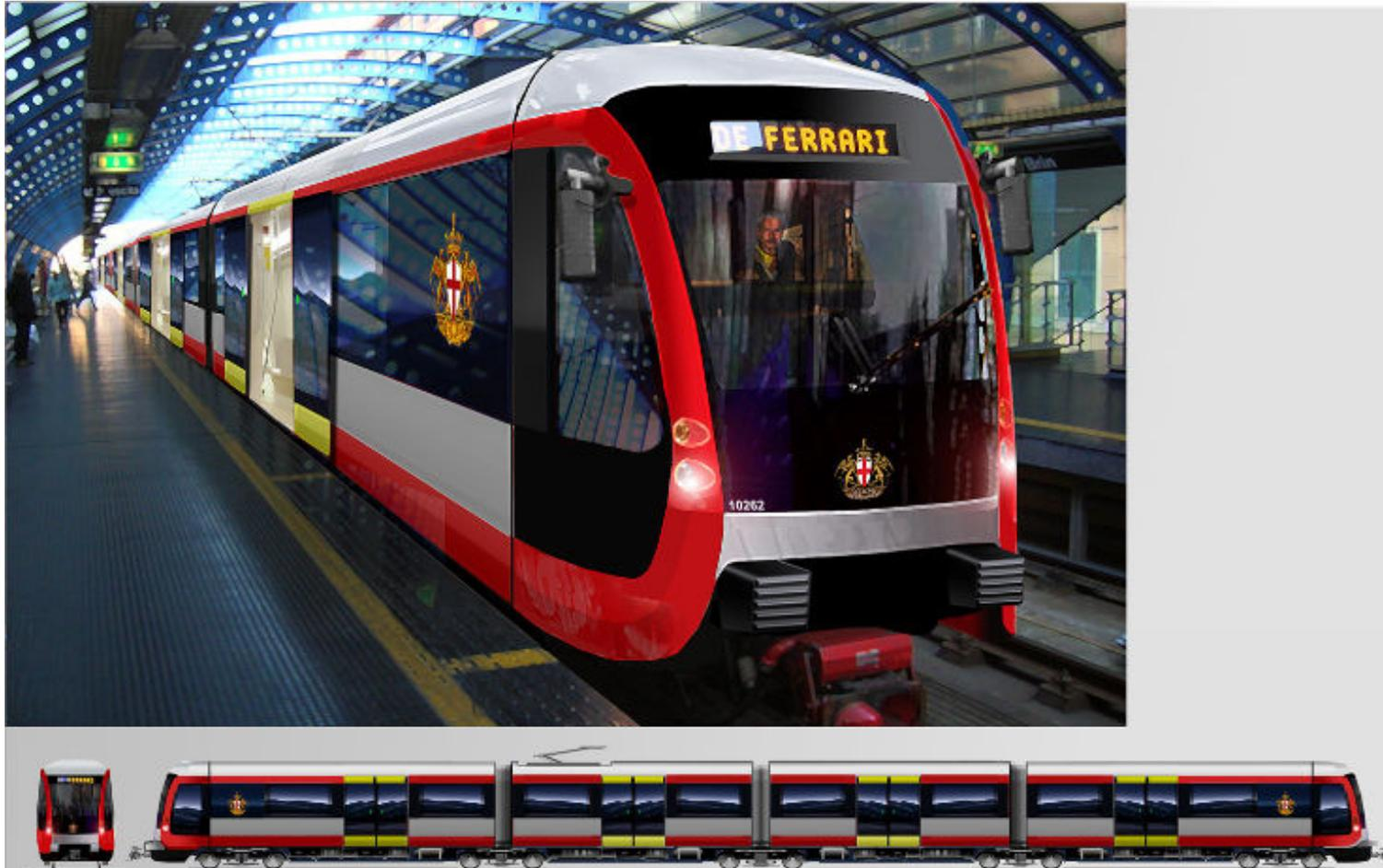
SI TRATTA DI CONVOGLI DI NUOVA GENERAZIONE, PROGETTATI E REALIZZATI SECONDO STANDARD TECNOLOGICI ATTUALI, LUNGHI 39 mt, LARGHI 2,20 mt, COSTITUITI DA 4 CASSE E 5 CARRELLI ED IN GRADO DI TRASPORTARE CIRCA 300 PASSEGGERI. SONO EQUIPAGGIATI CON MODERNI SISTEMI DI SICUREZZA DELLA MARCIA CONFORMI AGLI STANDARD E NORMATIVE DI SETTORE.
